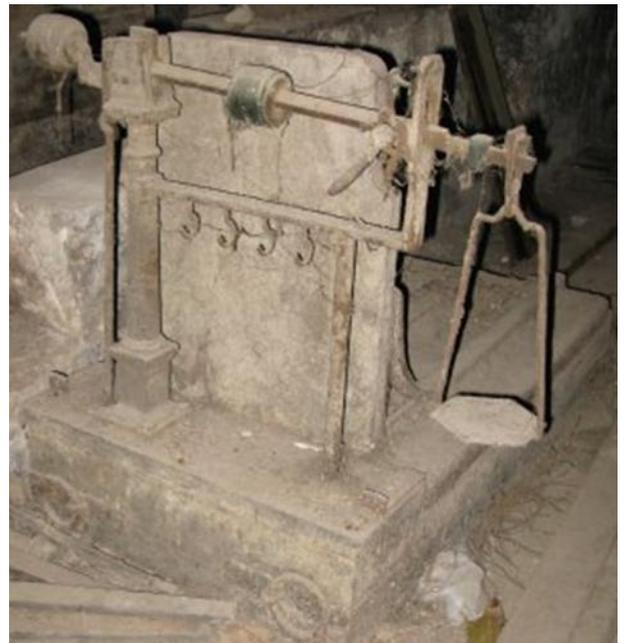
*Arrière de bascule avec ses crochets à suspendre des petits sacs
